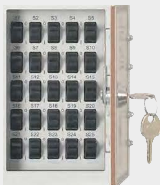
Имитатор 25 видов неисправностей посредством переключателей
