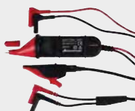
Зажим и пробник Кельвина
