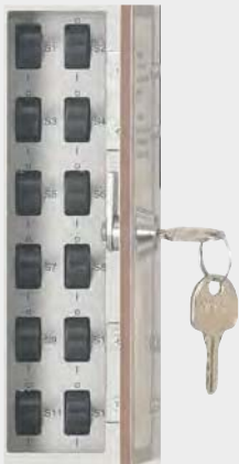
Имитатор 12 видов ошибок посредством переключателей
