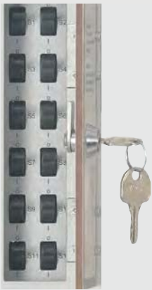
Имитатор 12 видов ошибок посредством переключателей
