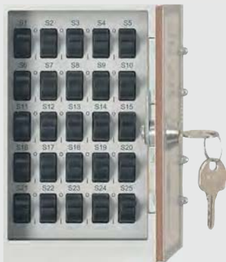
Имитатор 25 видов ошибок посредством переключателей
