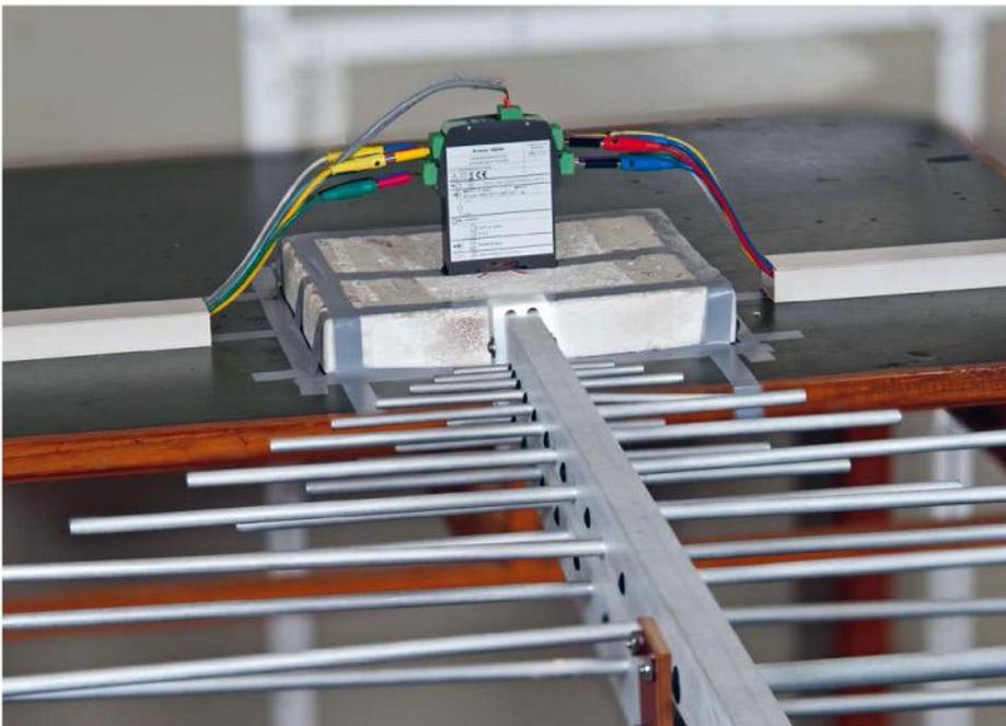
Испытание SINEAX V604s на устойчивость к радиочастотным полям
