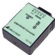
USB-RS485, с гальванической развязкой, для моделей SINEAX V604s, VB604s, VR660, APLUS, SINEAX CAM и SINEAX DME401/440
