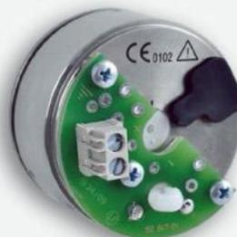
Соединительная плата с винтовыми клеммами
