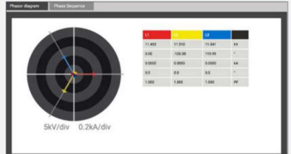
Schemat wektorowy do kontroli połączeń
