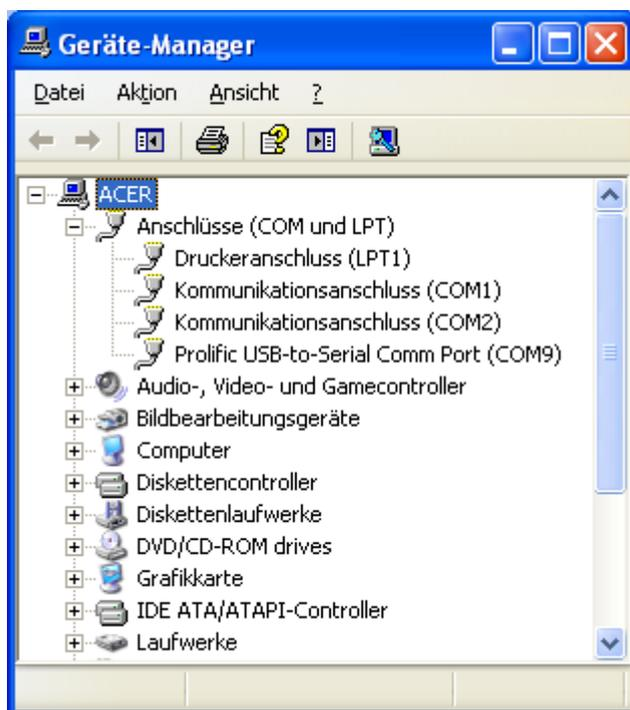
Unter „Anschlüsse“ finden Sie die Schnittstelle des USB Adapters.
