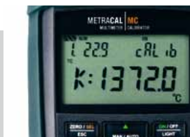
Wielopozycyjny wyświetlacz mogący wskazywać funkcję/wielkość, wartość wyjściową lub wartość mierzoną i symulowaną, itp.
