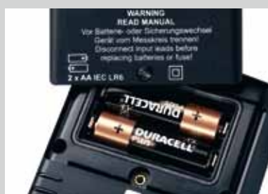
Odseparowana część przyrządu zawierająca baterię
