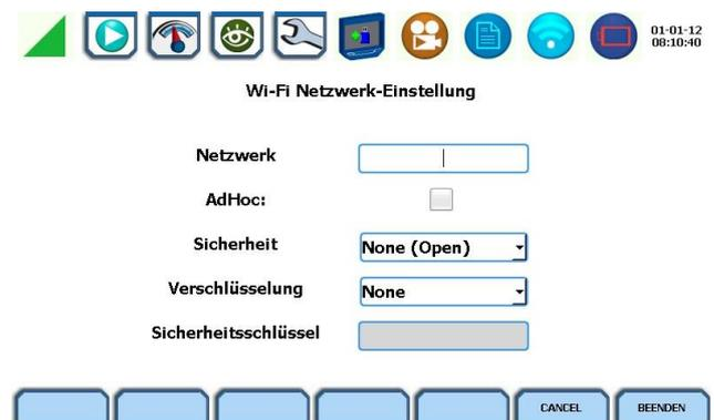
Markieren Sie das Kontrollkästchen "AdHoc", um die Verbindungsart freizugeben und klicken Sie in das Feld "Netzwerk". Im folgenden Dialogfeld können Sie eine Bezeichnung für das neue ad-hoc-Netzwerk eingeben. Bestätigen Sie die Bezeichnung mit "OK". Nach etwa einer Minute wird das neue ad-hoc-Netzwerk aktiviert.
