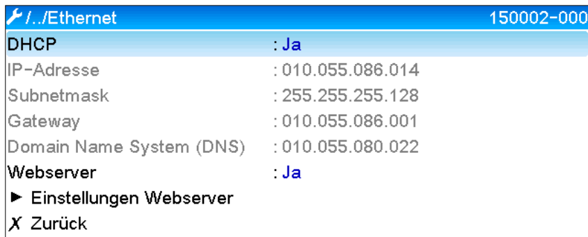
Abb. 3: Einstellungen der Ethernet Schnittstelle
