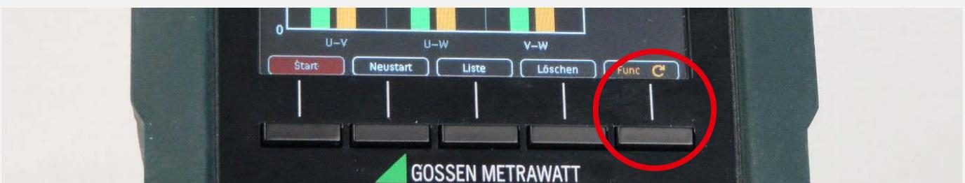
5. Используйте функциональную клавишу «Start» на METRAHIT IM, чтобы начать измерения.
