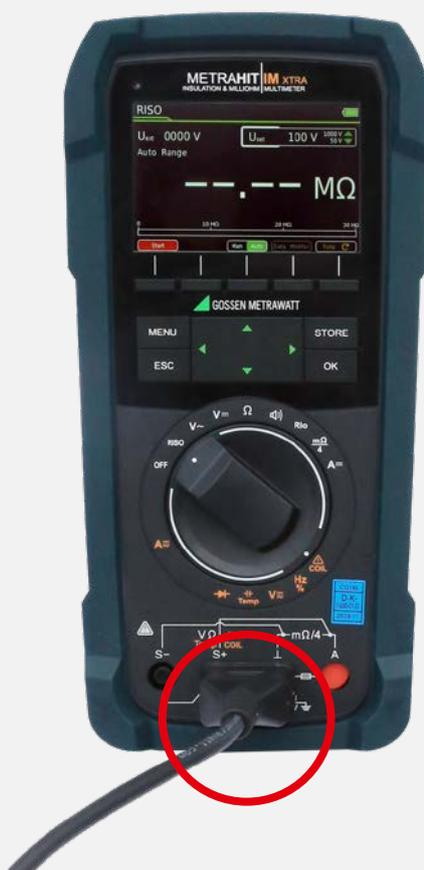
2. На втором этапе тестовые кабели подключаются к COIL ADAPTER XTRA и подключаются к измеряемому устройству. (Мы рекомендуем использовать дополнительные зажимы типа «крокодил» для подключения к обмоткам двигателя).
