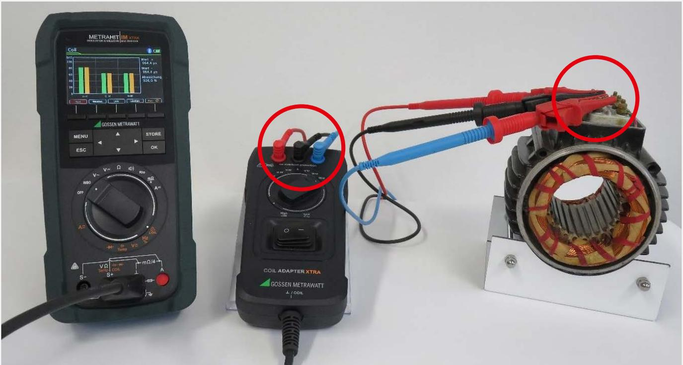
3. После выбора подходящего диапазона индуктивности для обмотки с помощью поворотного переключателя на COIL ADAPTER XTRA и установки METRAHIT IM на RISO можно начинать измерение.
