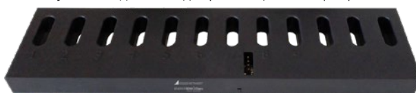
Рисунок 4: Блок контроля с двенадцатью цепями
